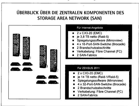
Die Speichemetzwerke und zentralen Speichersysteme sind redundant ausgelegt und werden räumlich getrennt betrieben. Durch Lastverteilung und Datenspiegelung zwischen den Standorten (Brandabschnitten) wird eine hochverfügbare Datenhaltung sichergestellt.
